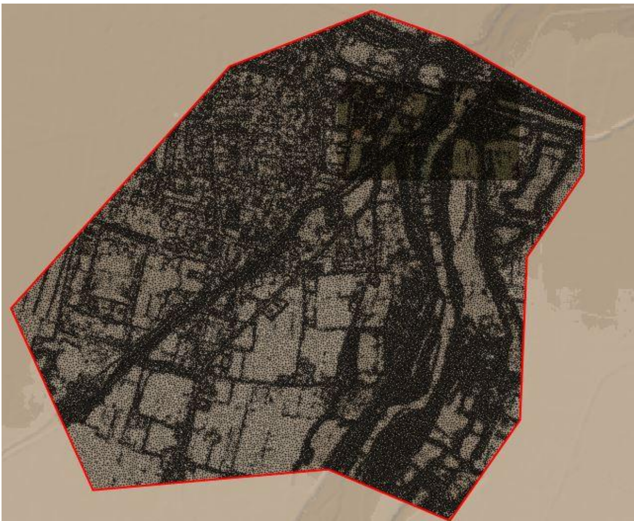
Figura 12 - Vista del dominio bidimensionale e delle celle di calcolo
