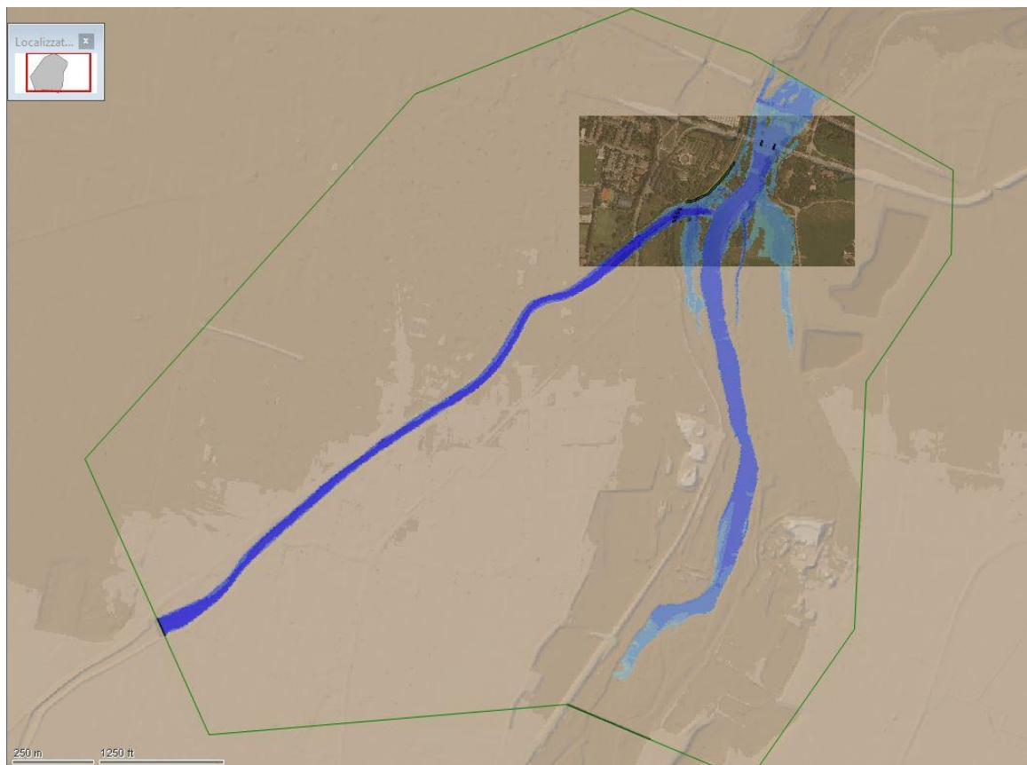
Figura 34 - Vista del modello idraulico bidimensionale - aree allagabili per TR200 TRESINARO - SDP
