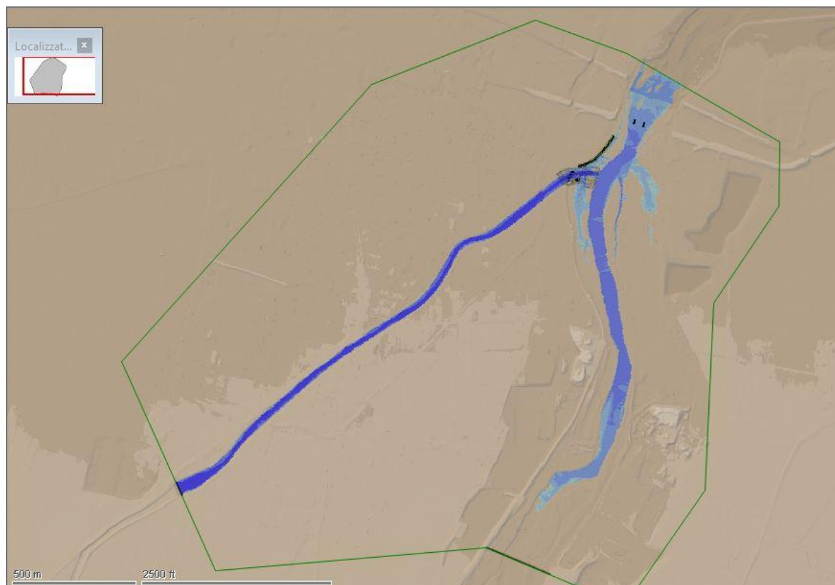
Figura 38 - Vista del modello idraulico bidimensionale - aree allagabili per TR200 TRESINARO – SDP portale + scatolari
