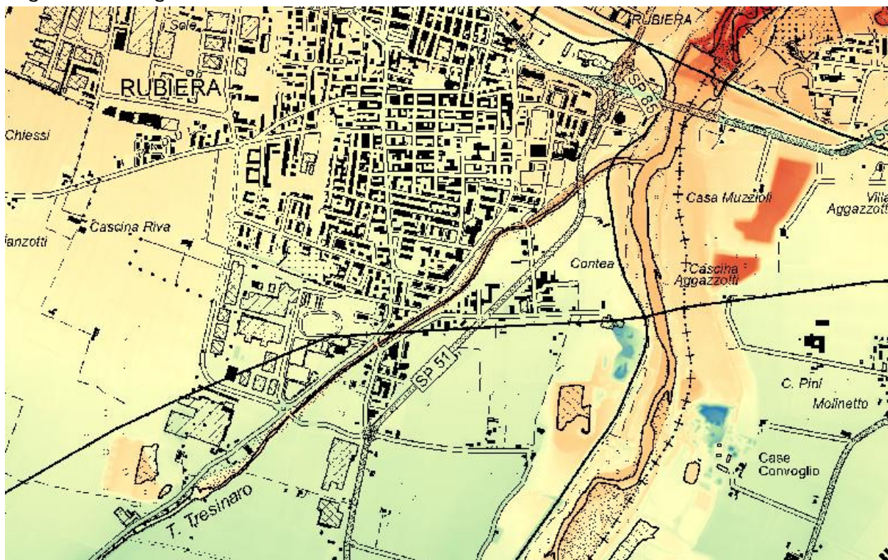
Figura 9 - Vista del Modello del terreno estratto per le modellazioni idrauliche
