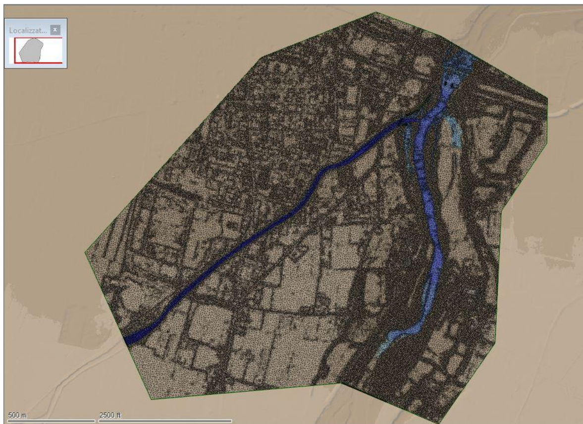
Figura 42 - Vista del modello idraulico bidimensionale - aree allagabili per TR200 TRESINARO – SDP con portale
