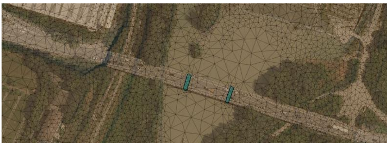
Figura 15 - Estratto del modello (maglia) con indicazione del viadotto della Via Emilia
