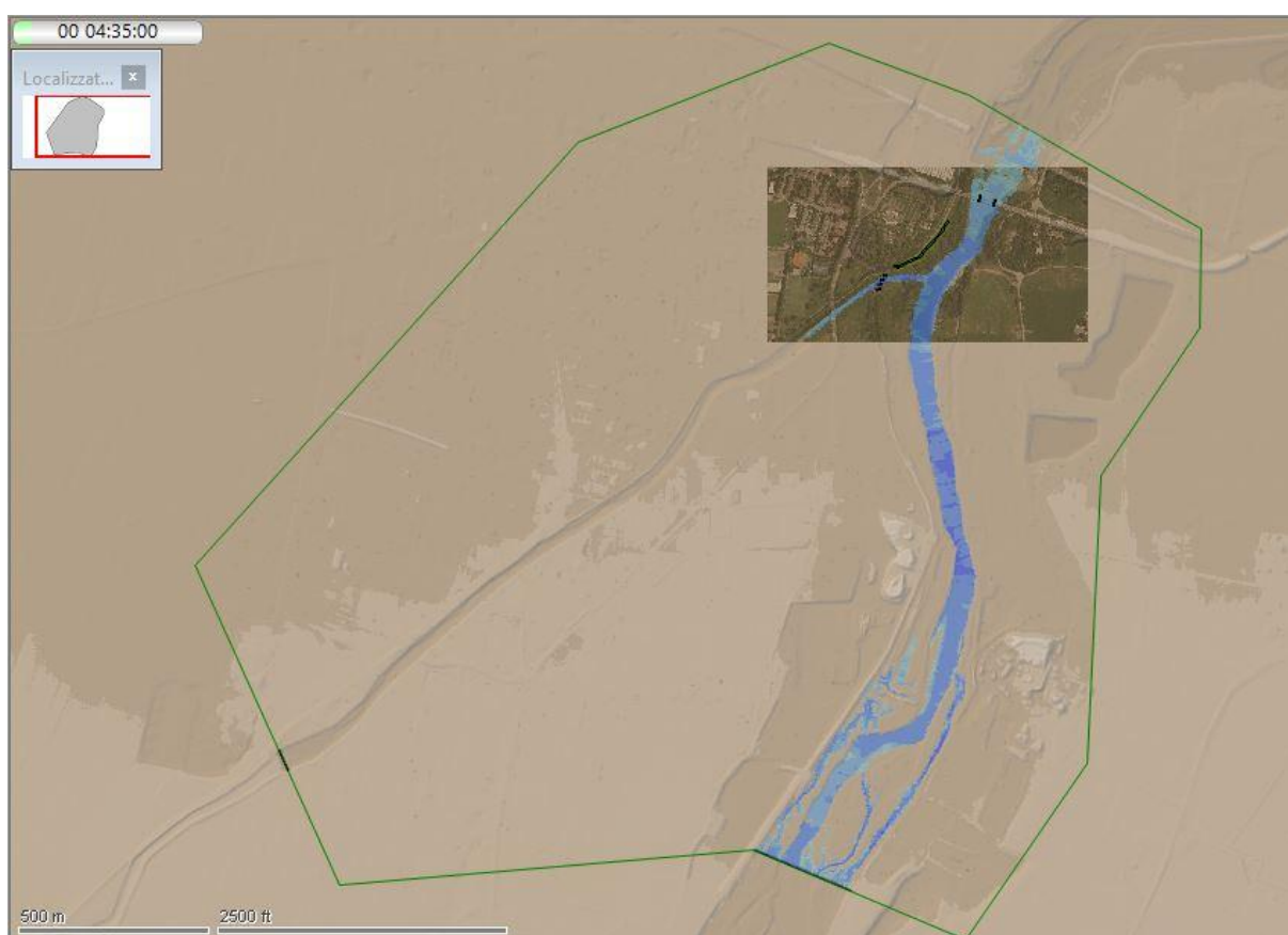
Figura 20 – Estratto della modellazione del fiume Secchia dopo 4 ore e 35 minuti di simulazione (idrogramma)
