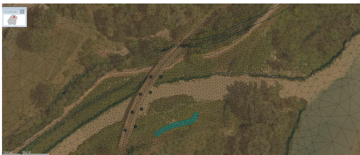
Figura 29 - Vista della zona di inserimento della passerella con indicazione del rilevato e infittimento della maglia di calcolo
