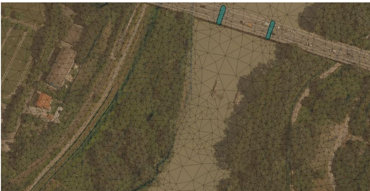
Figura 13 - Esempio di magliatura adattiva in funzione dell'altimetria (operata dal software)
