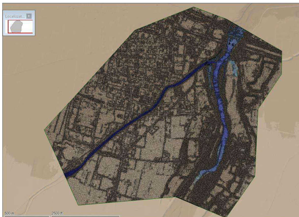
Figura 40 - Vista del modello idraulico bidimensionale - aree allagabili per TR200 TRESINARO – SDP con portale
