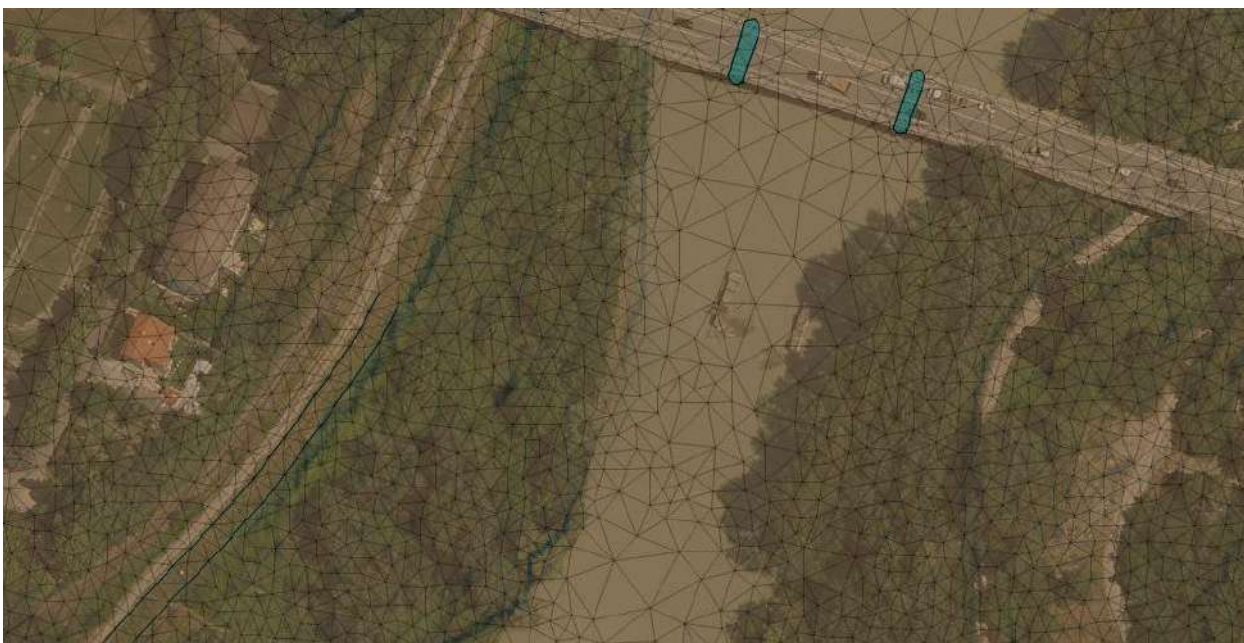
Figura 11 - Esempio di magliatura adattiva in funzione dell'altimetria (operata dal software)
