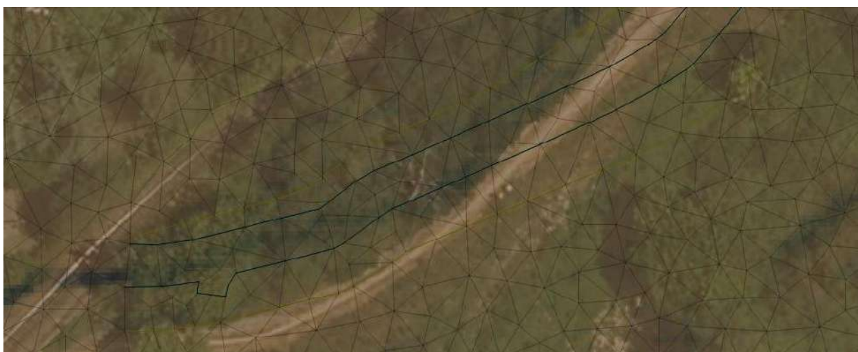
Figura 12 - Estratto del modello (maglia) con breaklines arginali
