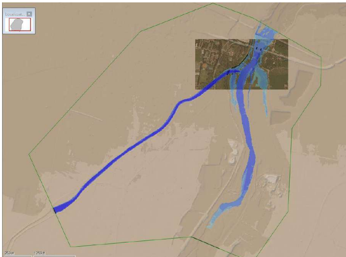
Figura 32 - Vista del modello idraulico bidimensionale - aree allagabili per TR200 TRESINARO - SDP
