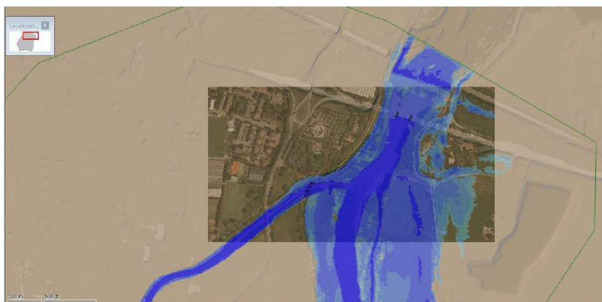
Figura 23 - Vista del modello idraulico bidimensionale - aree allagabili per TR200 di entrambi i corpi idrici
