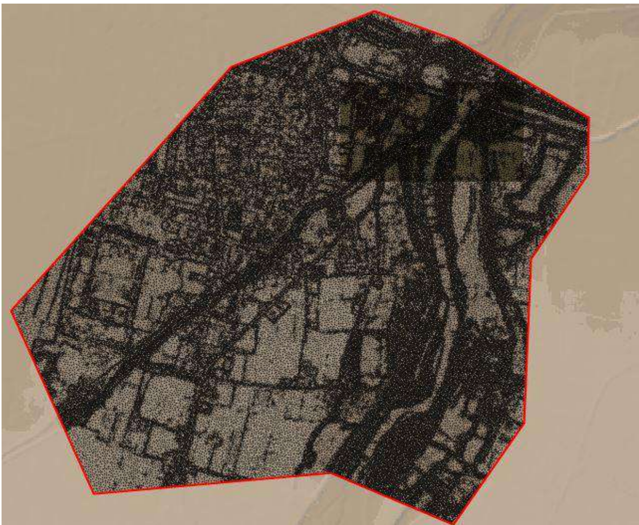
Figura 10 - Vista del dominio bidimensionale e delle celle di calcolo
