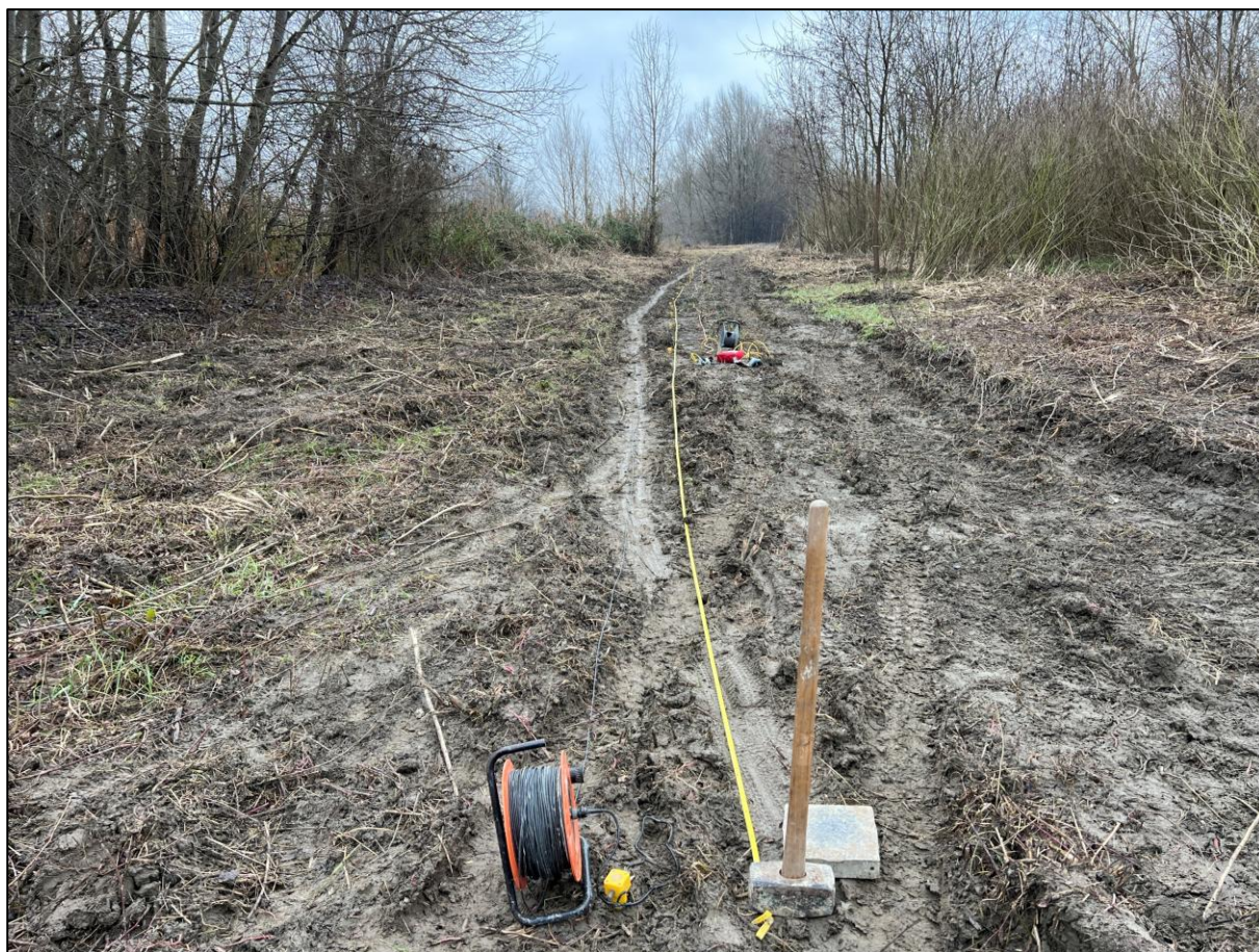
Fotografia 4 – Ripresa fotografica dello stendimento sismico eseguito
