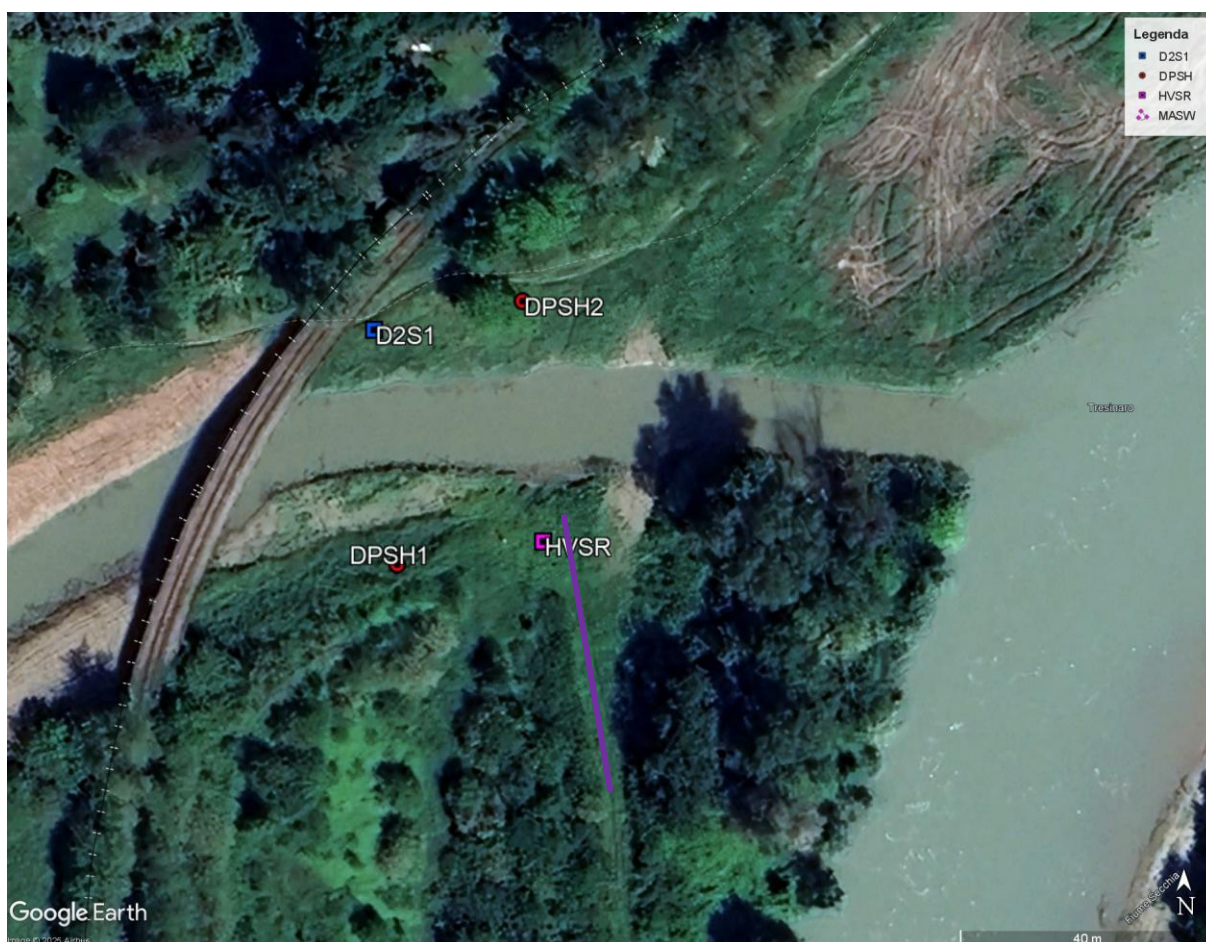
Figura 10 – UBICAZIONE INDAGINI GEOGNOSTICHE E GEOFISICHE
