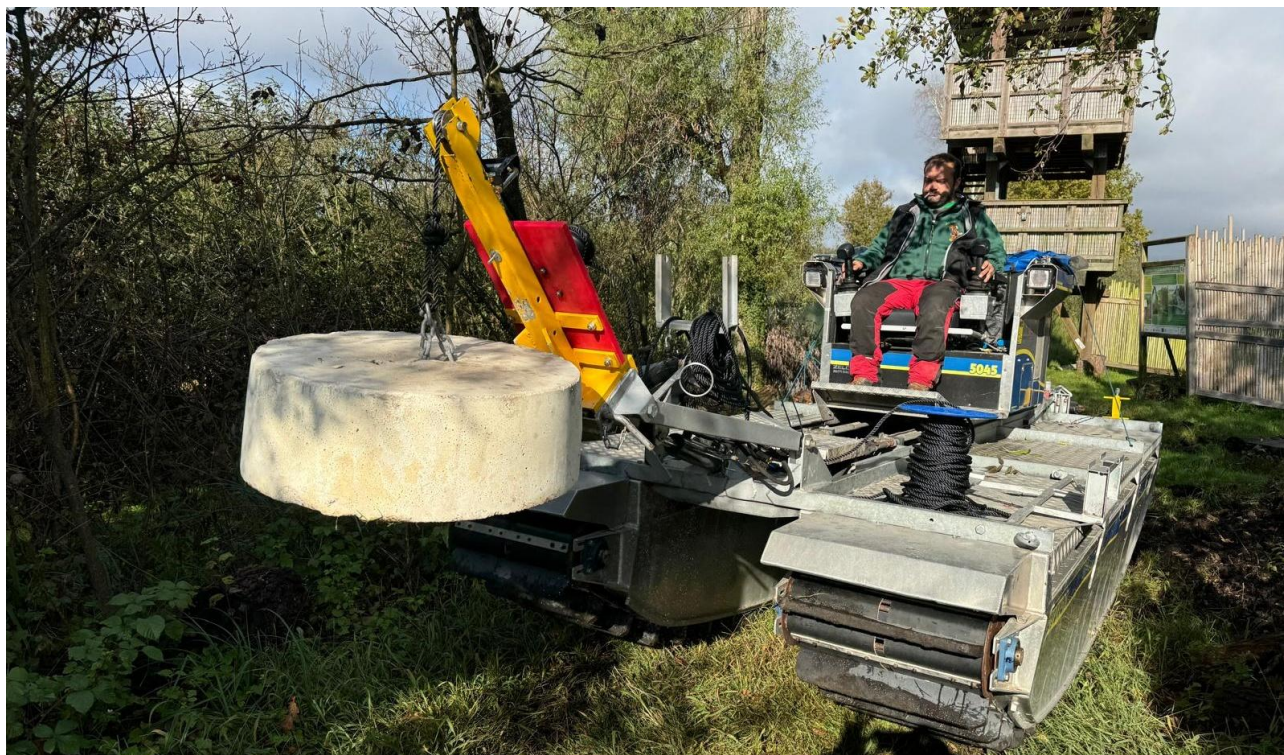
Figura 12 - Esempio di utilizzo del mezzo anfibio per trasporto corpi morti
