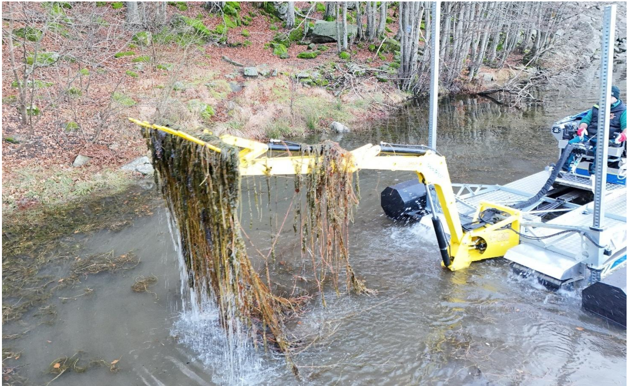
Figura 39 – Mezzo anfibio con rastrello dragante a catena (intervento sperimentale sul Lago Santo - anno 2024)
